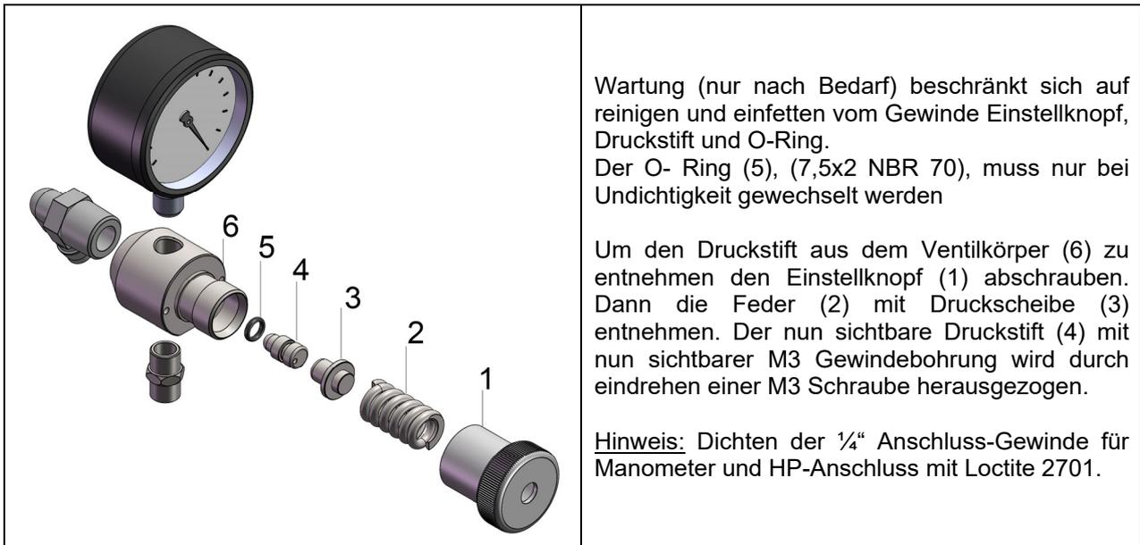
Wartung (nur nach Bedarf) beschränkt sich auf reinigen und einfetten vom Gewinde Einstellknopf, Druckstift und O-Ring.
