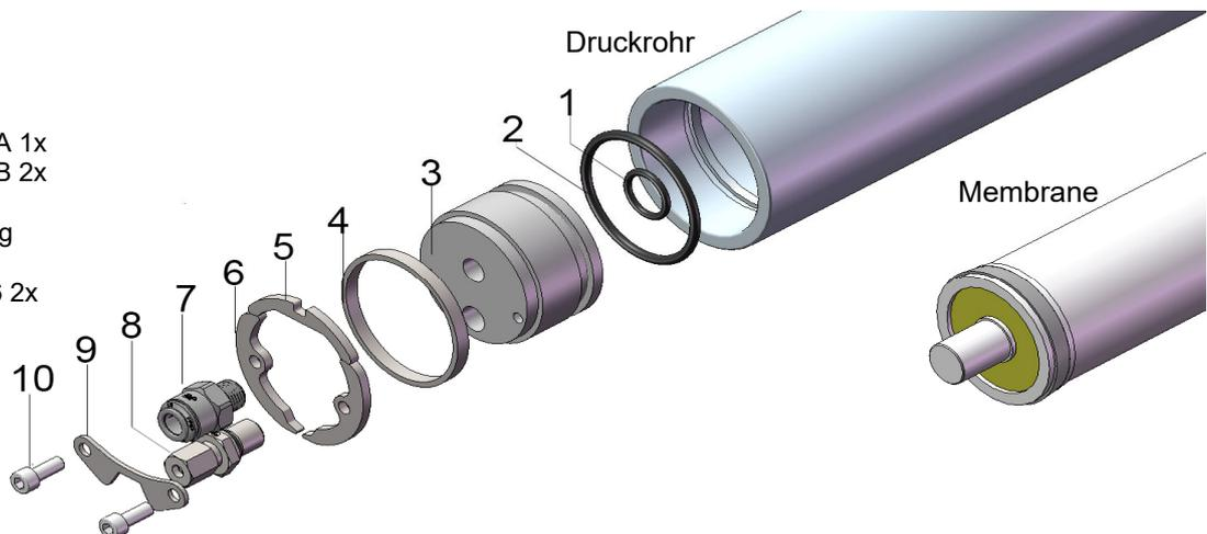
Das Herausschieben der Membrane sollte in Flussrichtung Seewasser aus dem Druckrohr geschehen, da der Gummi V-Ring der Membrane ein Schieben gegen die Flussrichtung erschwert.
